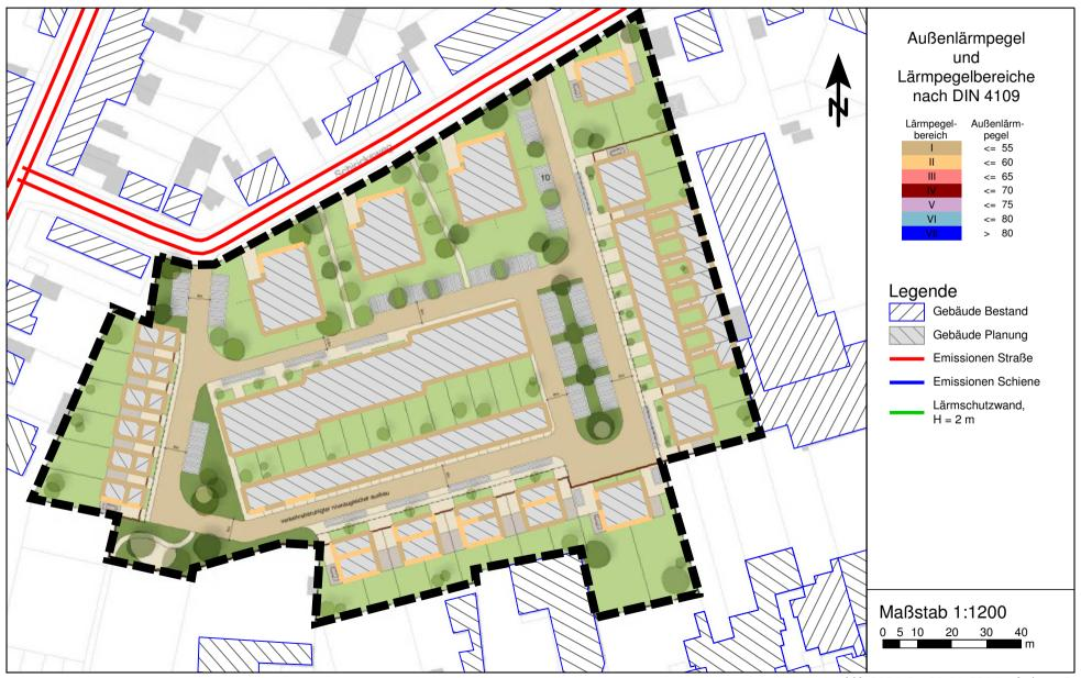
Lageplan mit Kennzeichnung der Lärmpegelbereiche gemäß DIN 4109 flächenhaft für das Plangebiet, ohne Abschirmung / Reflexion der geplanten Gebäude Rechenhöhe: 2,40 m über Gelände (EG)
